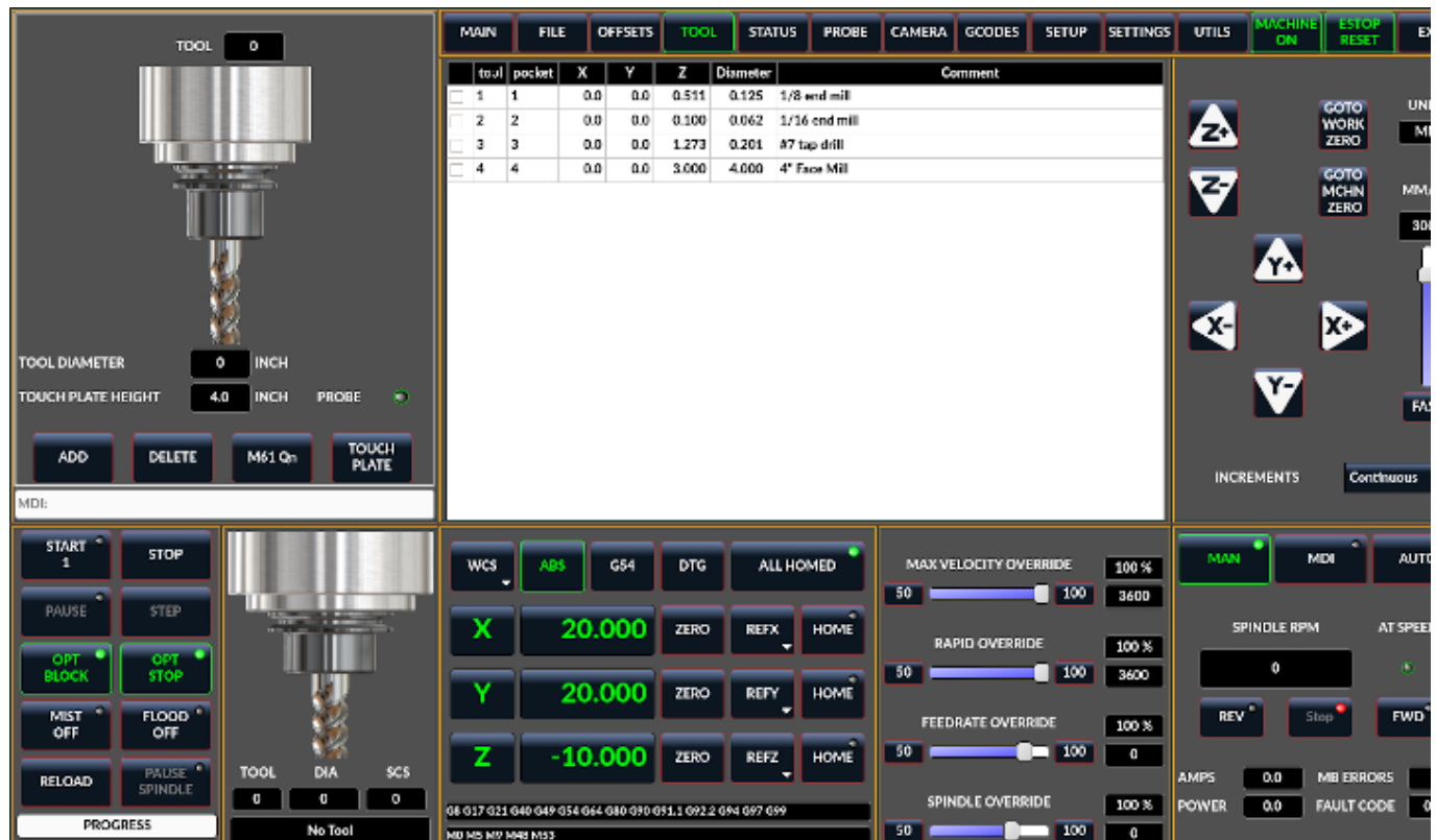
Abbildung 10.31: QtDragon Touch-Fläche (engl. touch plate)
